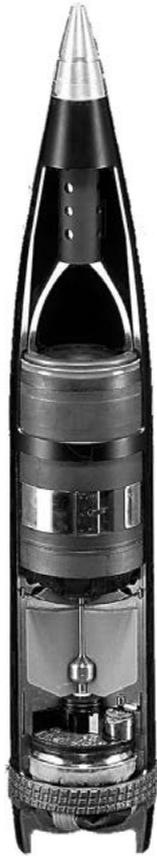
Coupe verticale d'un obus SMARt de 155 mm. On distingue nettement les deux sous-munitions dites « intelligentes ». Chacune de ces charges dispose d'un système d'autodestruction si aucune cible de devant être touchée.
